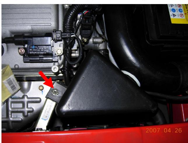
4. 拆卸空气滤清器 壳体盖和空气滤清器 出气管。
